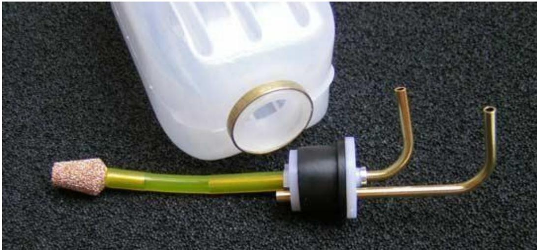
Avant qu'on mette aux raccords les tubes de laiton dans le réservoir, la vis et la mère est encore fixée au milieu. Si on met maintenant la vis, se pince des raccords noirs en dehors à un faux cou et isole celui-ci. En dehors du fait d'éviter d'arracher un faux cou, et de faire attention à un siège droit du volume de laiton au goulot de bouteille! Le montage du réservoir à la motocyclette est en principe à volonté.
