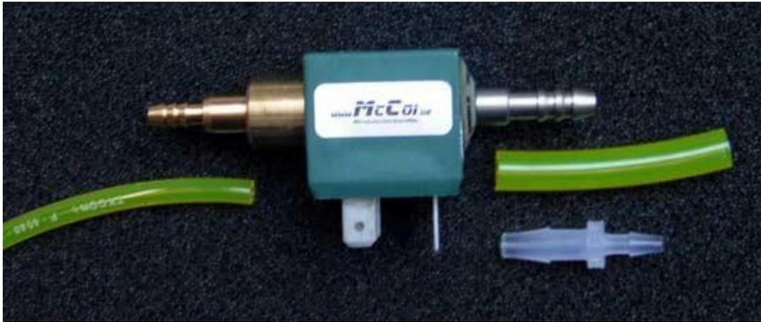
Le tuyau flexible mince est mis directement à l'entrée de pompes (laiton). Cela est un peu lourd, cependant, il s'assoit aussi très bien! Un léger élargissement du tuyau flexible avec une pince ou un stylo à bille peut aider. Cependant ne le chauffez pas, autrement le tuyau flexible fond.
